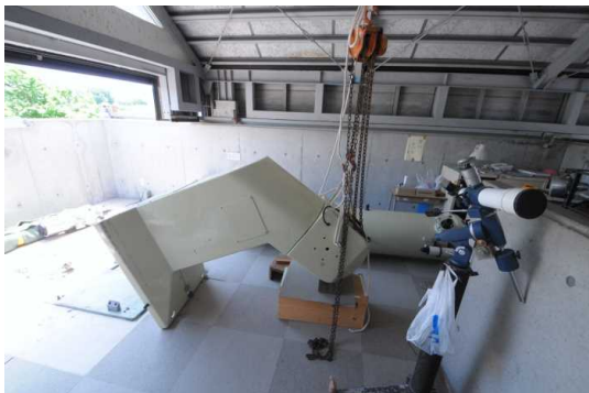
チェーンブロックでつり上げ、倒れた望遠鏡を分解
