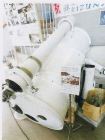
3.11 震災で主軸が折れ落下した 65cm 望遠鏡。展示？してあった。
