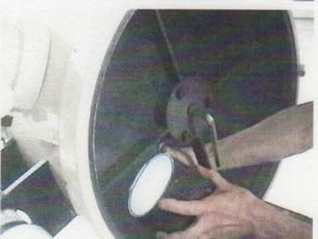
ように、斜鏡と斜鏡金具の双方に蛍光テープで作った合わせマークを貼り付け、それから中央のボルト1本だけをゆるめて、斜鏡を取り外しました。
