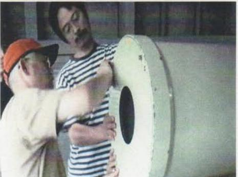
3本の取り付けボルトを、均等にトルクがかかるように、順番に締め付ければ、鏡の取り付け作業は無事に終了です。主鏡・斜鏡とも合わせマークをしておいたので、取り付け位置を再調整する必要がなく、ここまで予想以上にスムーズに作業が進みました。
