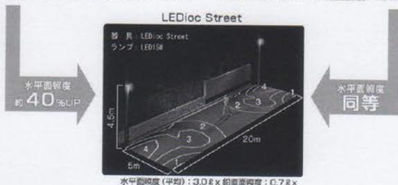
光源は3個の高輝度LED、3方向に光束をうまく配分しているのので、上方光束はとて少なく抑えられ、道路に沿って
