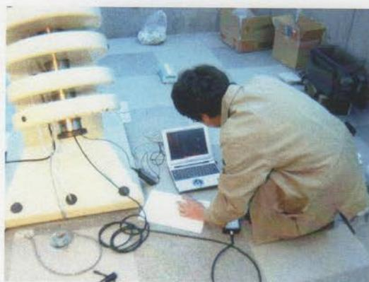
次は、制御回路とパソコンをつないでテスト。制御回路と駆動部との調整をとる作業も併せて行いました。赤経側の設定はすぐに完了。赤緯側はギア比の算出時にちょっとした間違いをして、何度かテストをやり直すことになりましたが、無事に設定値の割り出しができ、調整作業が完了しました。
