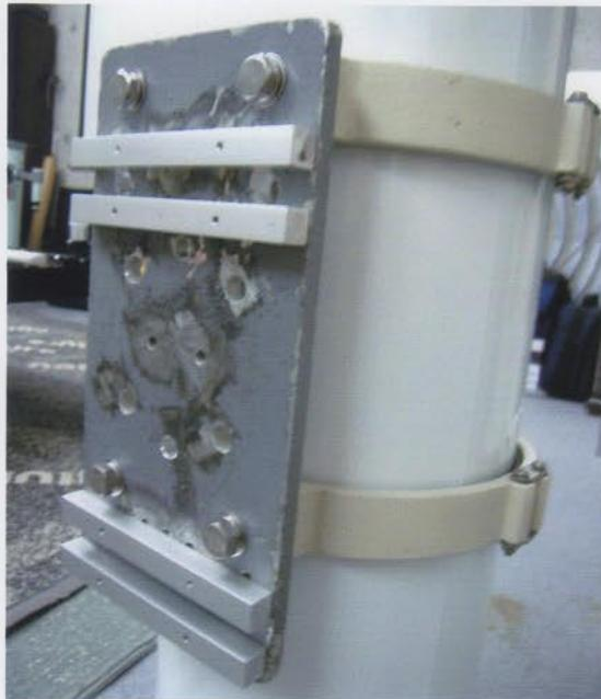
鏡筒バンドは、10mmボルト4本でプレートに取付。アルミの角棒を利用したスペーサーを取り付けて強度を確保しつつ、41cm鏡筒への取付を可能にしました
