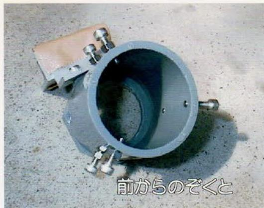
私の場合、加工の簡単な水道用塩ビ管の継ぎ手部品を買ってきて加工しています。ご覧のように、中にアイピースが入りますから、3方向からステンレスの4mmボルトを各2本ずつネジ込んで、光軸調整ができるようになっていました。ちょうど、望遠鏡のファインダー取り付け部分と同じです。
