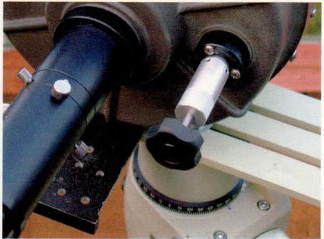
そのとき、CAN（冷却CCDのメーカーリスト）の中で紹介された富田五郎氏作成のこの装置を使ってみました。下の図を見れば分かる通り、一度ピントを合わせた後にノブをロックしてしまうというものです。
