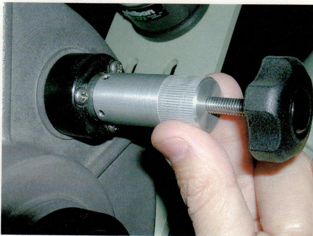
しかし、こんな望遠鏡のシステムですが、ただ一つ満足できないのがシュミットカセグレン特有のミラーシフトです。主鏡が望遠鏡の中で少しぐらついてしまうのです。ピントを主鏡の移動で行うために原理的に仕方がないのですが、困ってしまいます。
